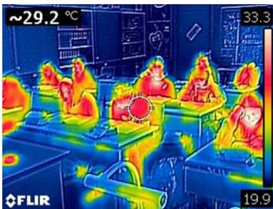
Im Schulhaus Kirchbünt kamen diese Modelle mehrfach zum Einsatz. Die **Wärmebildkamera** zeigt eindrücklich, was das Auge nicht sehen kann: Wärmestrahlung. Jeder Mensch ist eine Heizung im Raum! Auch elektrische Geräte leuchten im Display rot auf, weil Strom in Wärme umgewandelt wird.
